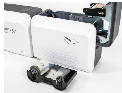
그림 22 라미네이터 필름 장착 2
