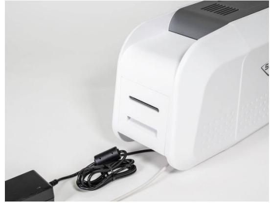
그림 10 SMART-51D 전원 및 통신포트 연결
