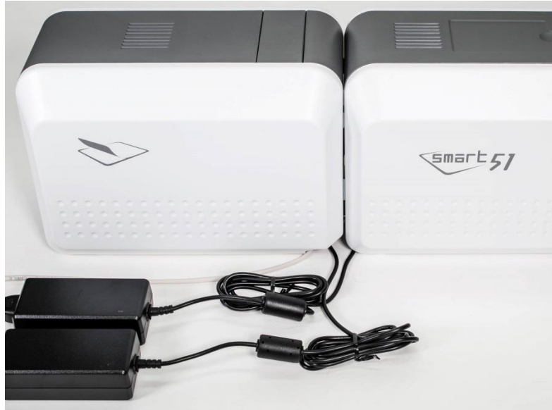
그림 12 SMART-51L 전원 및 통신포트 연결 - 2
