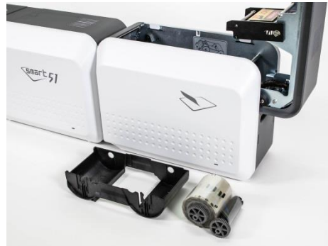
그림 21 라미네이터 필름 장착 1
