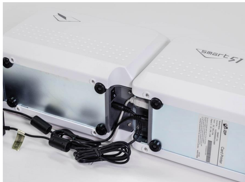
그림 11 SMART-51L 전원 및 통신포트 연결 - 1
