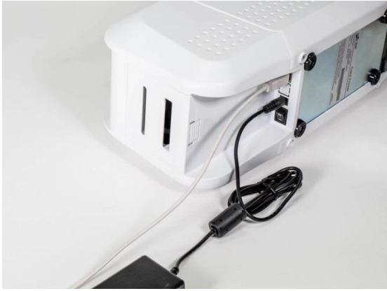
그림 10 SMART-51D 전원 및 통신포트 연결
